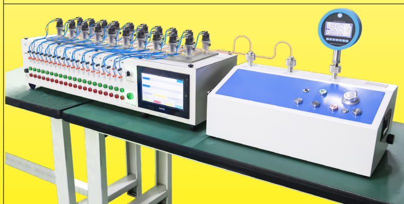
Überprüfung der Druckschalterkalibrierung
